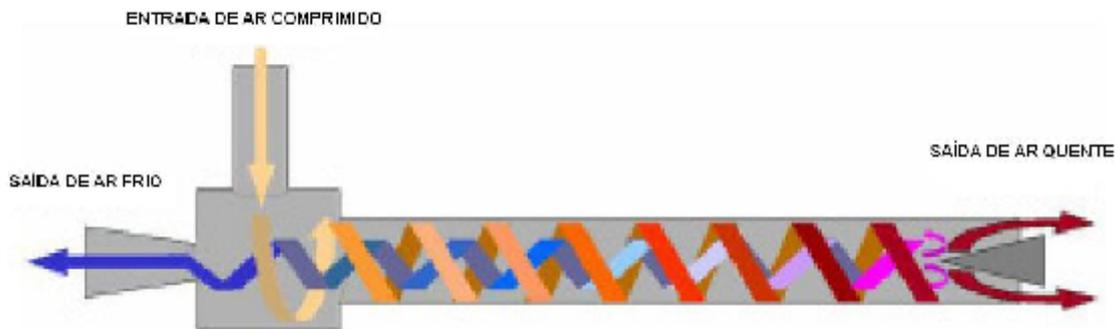
Figura 1. Disposição Básica do Tubo Vortex.
